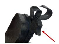
THE CLIP SHOULD INSTALL ON THE SIDE OF THE PAD WITH THE NOTCH FOR THE PIN.
