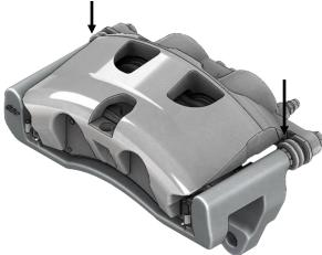
PLACE THE PAD CLIPS FROM THE ORIGINAL ANCHOR INTO THE NEW BAER ERADISPEED F-150 ANCHOR AND INSTALL THE CALIPER INTO THE NEW ANCHOR VIA THE SLIDING PIN HOLES. SLIDE THE END OF THE RUBBER BOOTS ONTO THE LIP OF THE SLIDING PIN HOLES IN THE BAER ERADISPEED F-150 ANCHOR. (<u>BRAKE HOSE NOT SHOWN IN</u> <u>PHOTO, DISCONNECTION OF ORIGINAL BRAKE HOSE NOT</u> REQUIRED)
