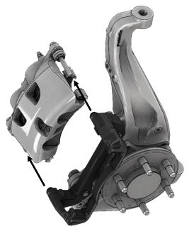
CAREFULLY REMOVE THE CALIPER FROM THE ORIGINAL ANCHOR BY SIMPLY PULLING THE CALIPER BODY (WITH THE SLIDING PINS INSTALLED) FROM THE ORIGINAL AN-CHOR. MAKE SURE NOT TO DAMAGE THE RUBBER BOOTS INSTALLED ON THE SLIDING PINS OF THE CALIPER. IT IS RECOMMENDED TO TEMPORARILY MOUNT THE CALIPER ASSEMBLY TO THE KNUCKLE TO AID IN REMOVING THE CALIPER FROM THE ANCHOR. (RIGHT KNUCKLE SHOWN) (BRAKE HOSE NOT SHOWN IN PHOTO, DISCONNECTION OF ORIGINAL BRAKE HOSE NOT REQUIRED)
