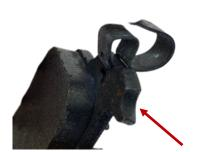
THE CLIP SHOULD INSTALL ON THE SIDE OF THE PAD WITH THE NOTCH FOR THE PIN.
